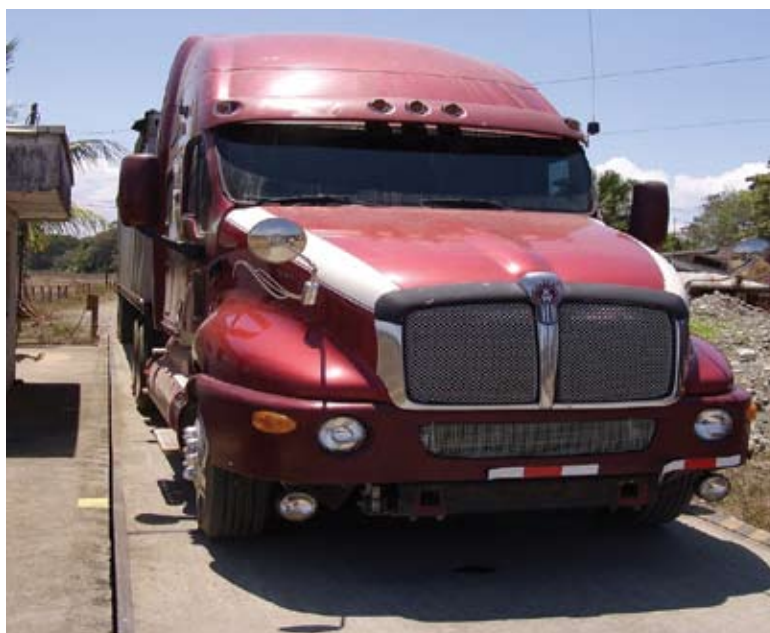
Figura 2: Prueba de repetibilidad. Se utiliza un camión cargado de arroz en granza o arroz pilado empacado con un peso que se aproxime al 50% de la capacidad máxima del instrumento y al 100% del mismo.
