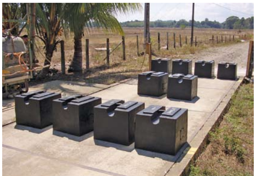
Figura 1. Prueba de excentricidad en la que se realiza la comprobación por sección mediante pares de puntos de apoyo. Se pueden utilizar pesas de una tonelada, un camión o un montacarga como carga. La segunda opción para realizar la prueba de la excentricidad consiste en efectuar la comprobación por puntos de apoyo
