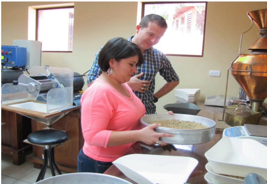
Yoheidy Chacón Aguilar, analista de Coopeliberia, durante el proceso de determinación del porcentaje de impurezas, supervisada por el Ing. Diego Jiménez, instructor del LCCC.
