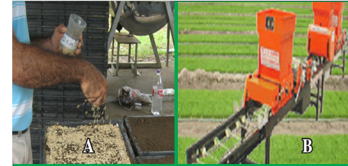
Figura 11. a) Siembra manual. b) Siembra mecanizada del semillero o almálico de arroz. Conarroz, 2011.
