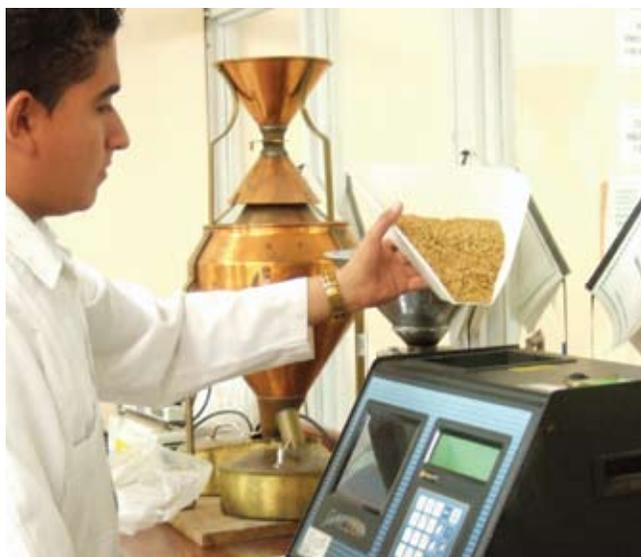
*Durman Herrera, asistente técnico del Laboratorio de Control de Calidad de Conarroz, determina el porcentaje de humedad de arroz en granza en el medidor de humedad marca Dickey-John GAC-2100.*
