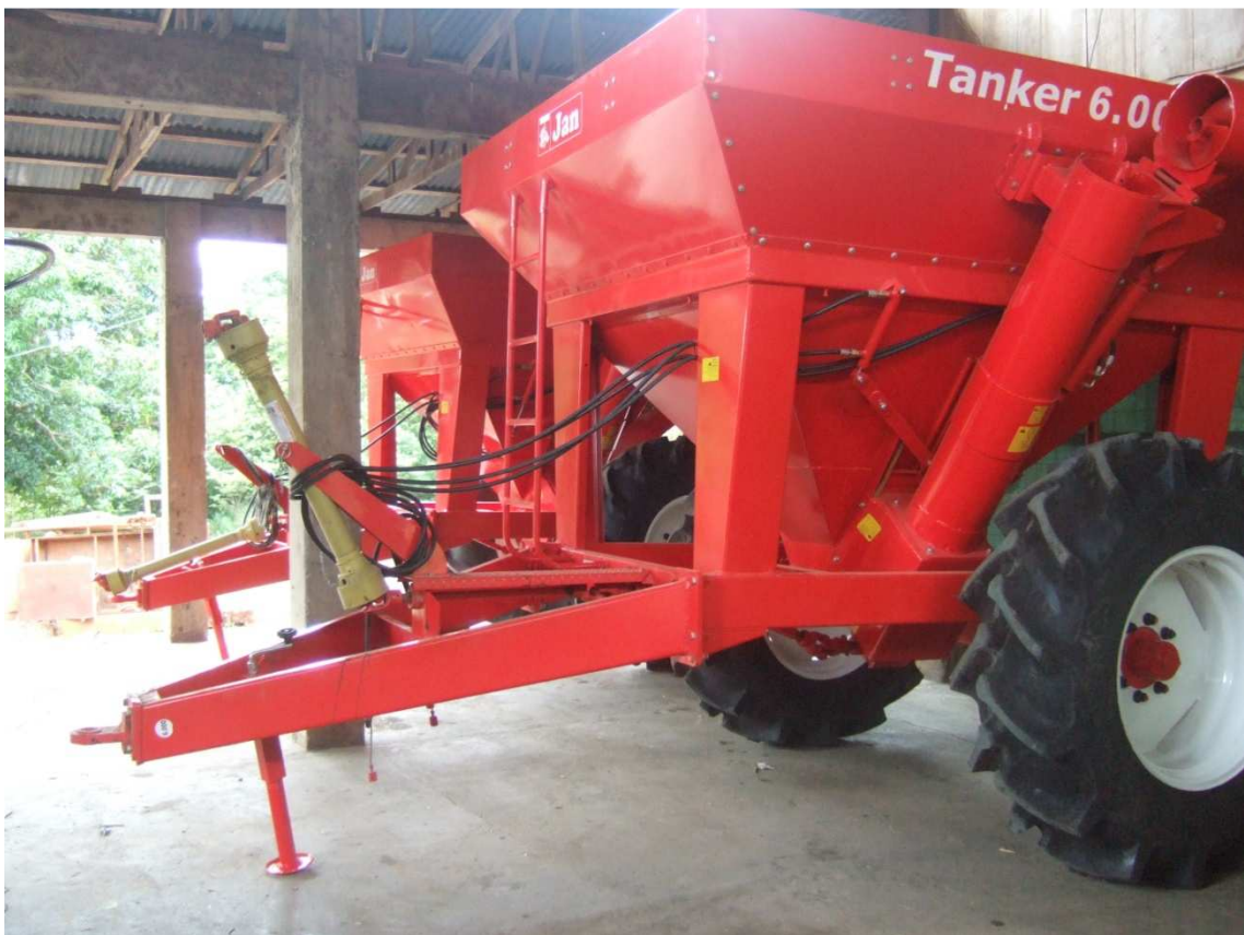
Tolvas granelera (Chompipa) JAN 6000
